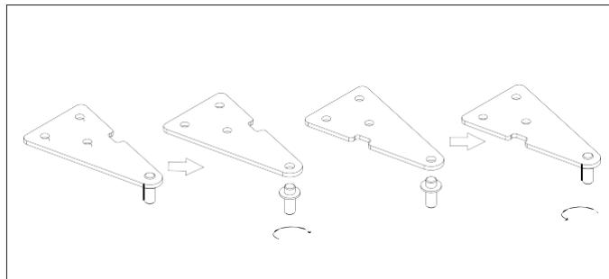
8. Volte a encaixar a porta superior e depois, a dobradiça superior no lado esquerdo. Certifique-se de que a porta está alinhada horizontal e verticalmente, para que a selagem esteja fechada em todos os lados antes de finalmente apertar a dobradiça superior. Se necessário, use uma chave para apertar a dobradiça.
