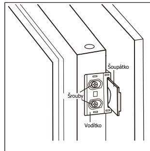
4. Společně otevřete dveře spotřebiče a dřevěné dveře. Jakmile dveře otevřete a zavřete ve všech úhlech, označte si polohu šoupátka. Šoupátko vyjměte z vodítka a přišroubujte jej pomocí krátkých šroubek ke dřevěným dveřím. Pak na šoupátko připevněte kryt šoupátka.
