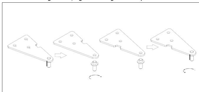
8. Sæt døren og derefter øverste hængsel på igen i venstre side. Sørg for, at døren er tilpasset vandret og lodret, således at tætningslisterne er lukkede på alle sider, før øverste hængsel tilspændes endeligt. Brug om nødvendigt en skruenøgle til at stramme hængslet.
