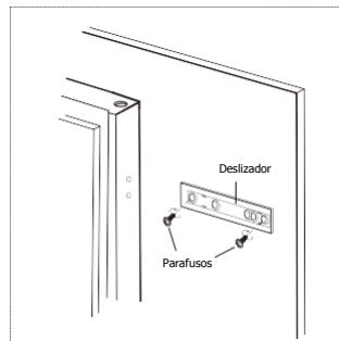
7. Encaixe duas guias com deslizadores e fixe-as com parafusos curtos. Depois, fixe as coberturas das guias com guias.
