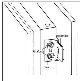
4. Abra a porta do aparelho e a porta de madeira em conjunto. Depois de a porta abrir e fechar a todos os níveis, marque a posição do deslizador. Retire o deslizador da guia e fixe o deslizador com a porta de madeira através dos dois parafusos curtos. Depois, fixe a cobertura do deslizador no deslizador.
