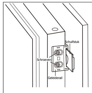
4. Open de toesteldeur en de houten deur samen. Zodra de deur onder alle hoeken opent en sluit, markeert u de stand van het schuifstuk. Neem het schuifstuk uit de geleiderail en bevestig het schuifstuk aan de houten deur met twee korte schroeven. Bevestig daarna de schuifstukbekleding op het schuifstuk.
