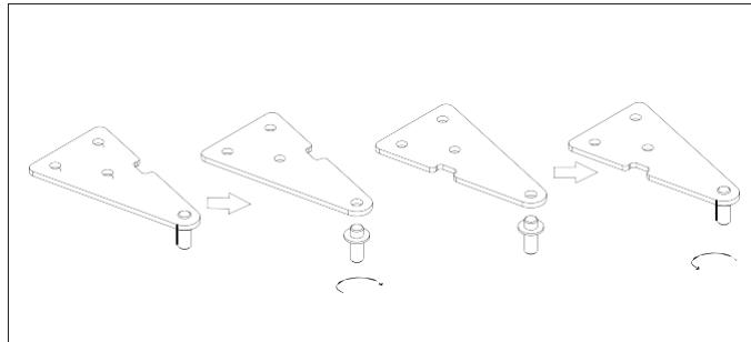
8. Breng de deur weer aan en daarna de bovenste scharnier aan de linkerkant. Zorg dat de deur horizontaal en verticaal is uitgelijnd, zodat de afdichtingen aan alle kanten dicht zijn vóór u ten slotte de bovenste scharnier vastdraait. Gebruik indien nodig een sleutel om de scharnier vast te draaien.
