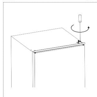
2. Schroef de onderste scharnier van de diepvriezerdeur los. Verwijder daarna de deur en plaats ze op een zacht oppervlak om krassen te vermijden.
