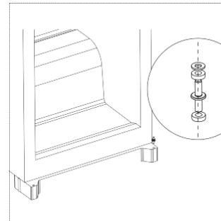
7. Odšroubujte čep z vrchního pantu. Pantem poté otočte a čep znova našroubujte.
