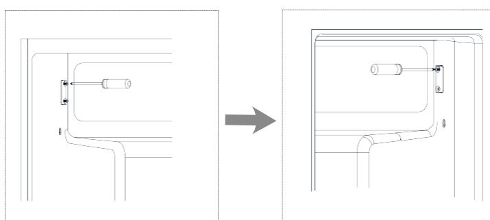
4. Přesuňte kryt otvoru v pantu z levé strany na pravou.
