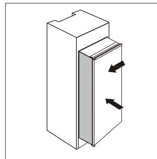
3. Schroef met korte schroeven een geleiderail op de gaten in de zijkant van de toesteldeur. Steek het schuifstuk in de geleiderail, open en sluit daarna de deur en de houten deur volledig om te controleren of de deur volledig en vlot kan sluiten.
