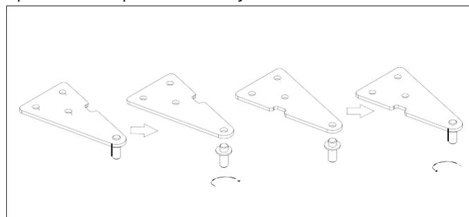
8. Namontujte dvířka a poté vrchní pant na levou stranu. Ujistěte se, že dvířka jsou vertikálně a horizontálně vYROVnaná, takže těsnění je na všech stranách uzavřené, a nakonec utáhněte vrchní pant. Pokud je to třeba, použijte k uTAŽENÍ pantu klíč.
