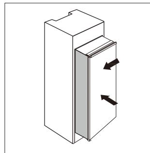
3. Pomocí krátkých šroubků přišroubujte do otvorů na straně spotřebiče vodítko. Do vodítka vložte šoupátko, poté zcela otevřete a zavřete dveře spotřebiče a dřevěné dveře, abyste zkontovali, že dřevěné dveře se zcela a plynule zavírají.
