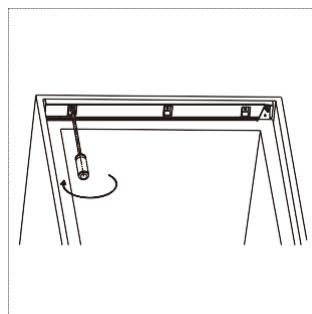
10. Bevestig rubberen afdichting aan de spleet tussen de eenheid en de houten kast aan de kant waar de deur opent.
