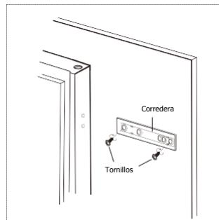
7. Fije las dos guías en las correderas con tornillos cortos. Luego fije los cubreguías.
