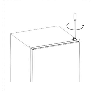
2. Skru nederste hængsel af fryserdøren. Derefter tages døren af, og den anbringes på et blødt underlag for at undgå at den ridses.
