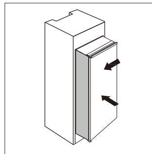
3. Aparafuse uma guia aos orifícios no lado da porta do aparelho com o parafuso curto. Introduza o deslizador na guia, depois, abra e feche totalmente a porta do aparelho e a porta de madeira para verificar se a porta de madeira pode fechar totalmente e com suavidade.
