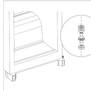
7. Schroef de bovenste scharnierpen uit de scharnier. Draai daarna de scharnier om en schroef de scharnierpen aan.
