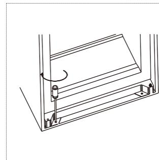
9. Fije el soporte superior al armario de madera con tornillos cortos.
