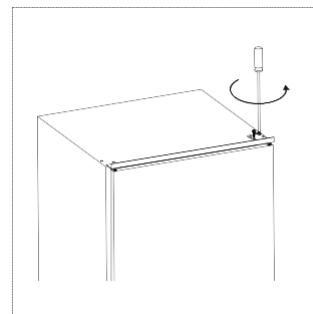
2. Desaparafuse a dobradiça inferior da porta do congelador. Depois, eleve a porta e coloque-a numa superfície almofadada para evitar riscos.
