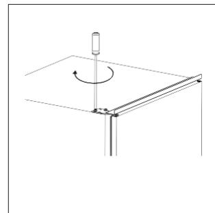
8. Fije la puerta y la bisagra superior en el lado izquierdo. Compruebe que la puerta queda alineada horizontal y verticalmente de manera que las juntas estén bien cerradas antes de apretar la bisagra superior. En caso necesario, utilice una llave para apretar la bisagra.
