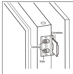
4. Abra la puerta del frigorífico y la puerta de madera a la vez. Cuando la puerta se abra y cierre en todos los ángulos, marque la posición de la corredera. Saque la corredera de la guía y fíjela a la puerta de madera con dos tornillos cortos. Fije entonces el cubrecorredera en la corredera.
