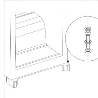
7. Desaparafuse o pino da dobradiça da dobradiça. Depois, gire a dobradiça e aparafuse o pino da dobradiça.
