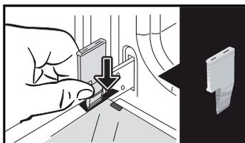
Retirez la première glace clippée : A l'aide de l'autre cale (ou d'un tournevis) appuyez dans les emplacements A afin de déclipper la glace.
