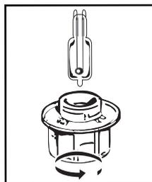
Vous pouvez remplacer vous-même la lampe lorsqu'elle ne fonctionne plus. Dévissez le hublot puis sortez la lampe (utilisez un gant de caoutchouc qui facilitera le démontage). Insérez la nouvelle lampe et remplacez le hublot.
